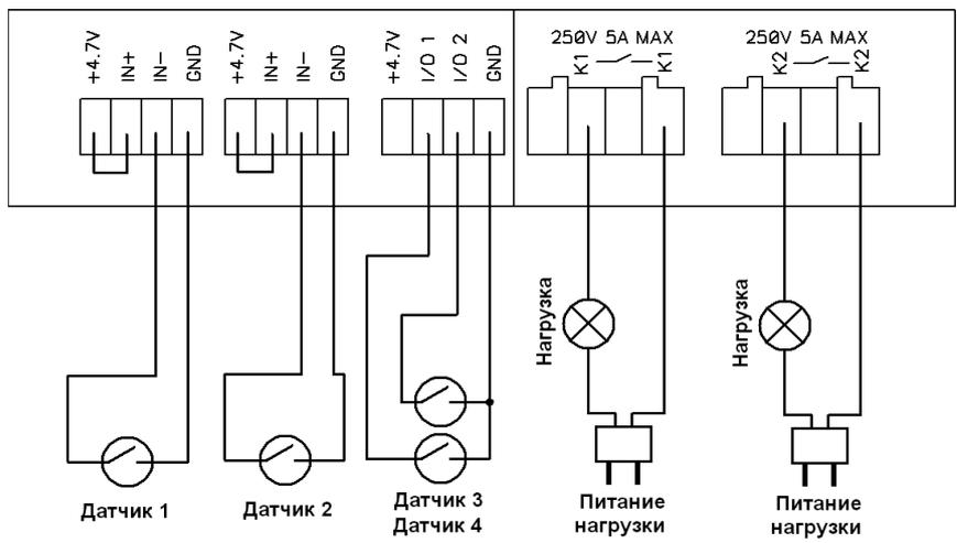
Рисунок 2. Подключение нагрузки и контактных датчиков к Блоку D-222
