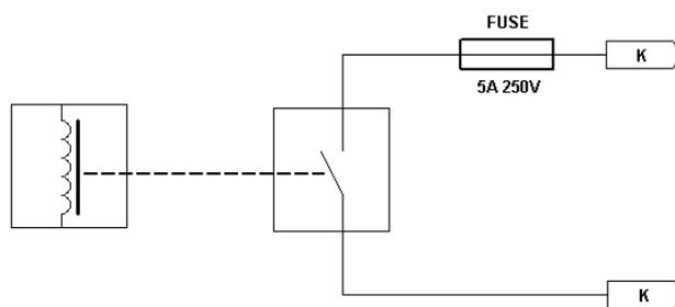
Рисунок 5. Схема канала управления нагрузками
