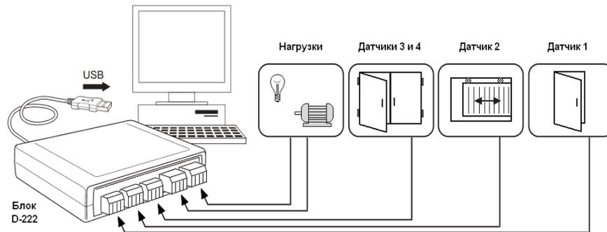
Рисунок 1. Система сбора информации и управления на основе Блока D-222
