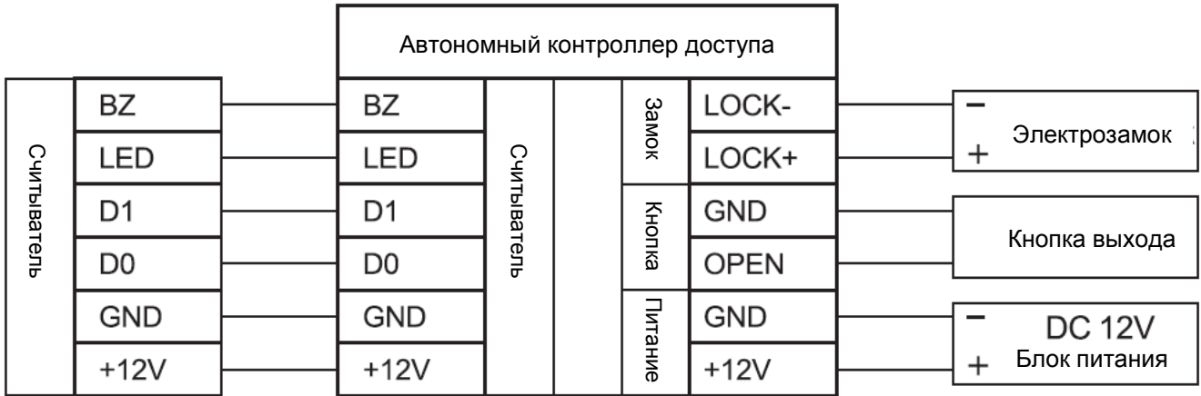
Рисунок 2: Схема подключения Считыватель
