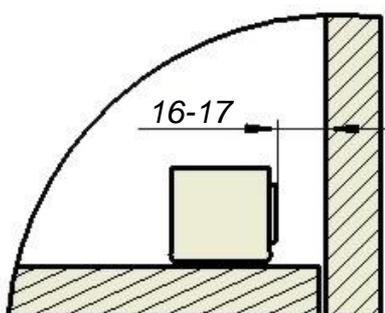
Установить блокиратор на неподвижной поверхности. Расстояние от внутренней поверхности закрытой двери до гайки блокиратора должно быть **16-17 мм**, что гарантирует необходимый свободный ход двери при закрытом замке в диапазоне **3-4 мм**
