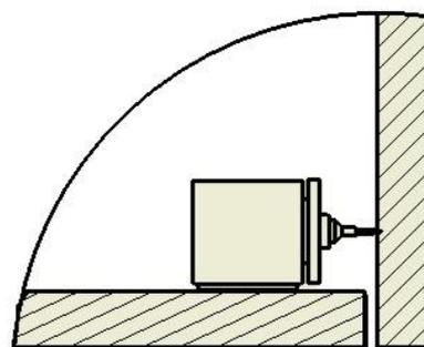
Вставить в блокиратор разметочный маркер и плотно закрыть дверь (ящик). При этом маркер оставит на поверхности двери след (точку). Наколоть на полученную отметку разметочный шаблон и разметить крепежные отверстия. Установить ригель.
