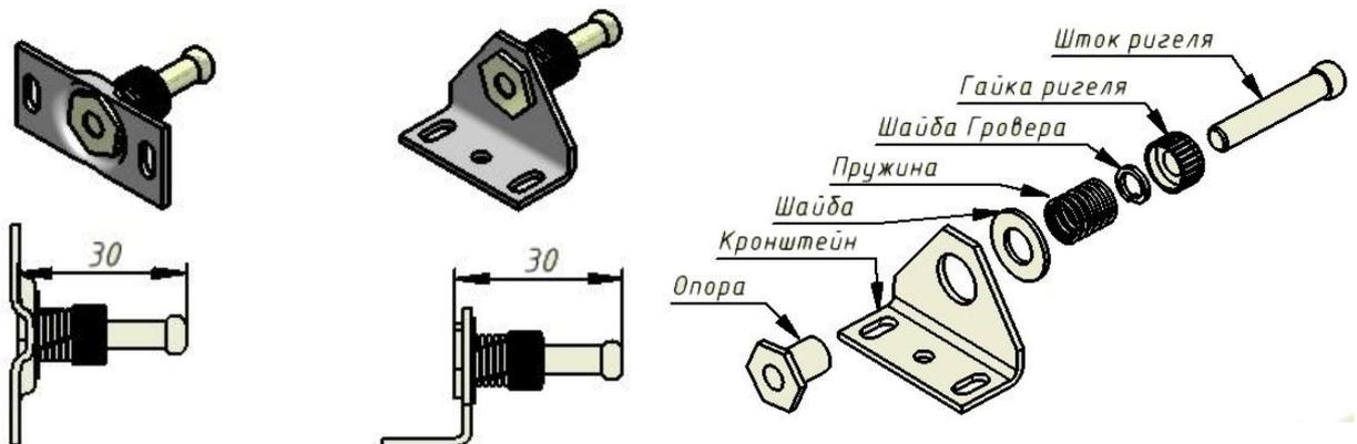
**НА ПЛАСТИНЕ РЕГУЛИРОВОЧНОЙ**
