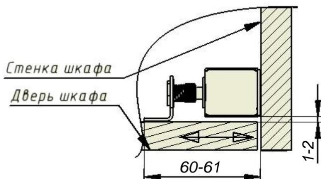
Закрепить блокиратор на стенке шкафа. На расстоянии 54-55 мм от стенки шкафа по центральной оси блокиратора на двери сделать отметку. Наколоть на полученную отметку разметочный шаблон и разметить крепежные отверстия. Собрать ригель на угловом кронштейне согласно рисунку (см. п.5.2) и закрепить его на двери.
