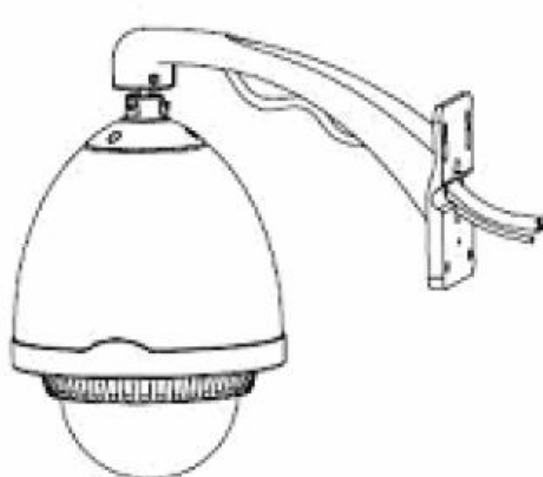
1. Проденьте кабель в отверстие кронштейна
