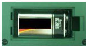
Рис. 3 Разъём для подключения щелочной батареи.
