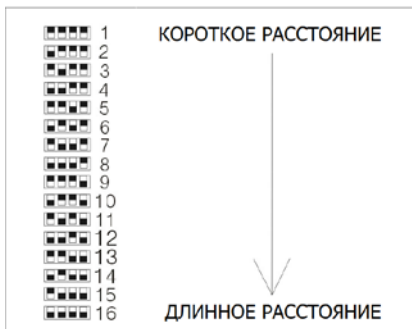
Рис.5 Комбинации DIP-переключателей на приёмнике RA-CA2
