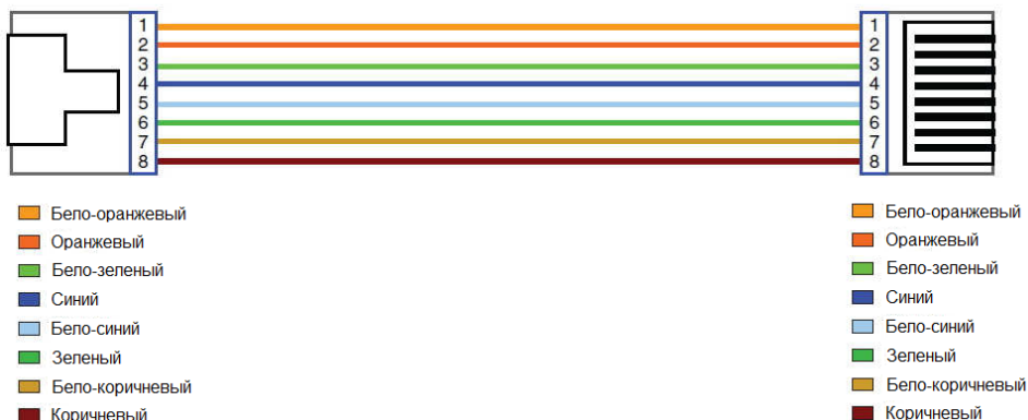
Рис. 10 Разводка кабеля по типу TIA/EIA-568-A.
