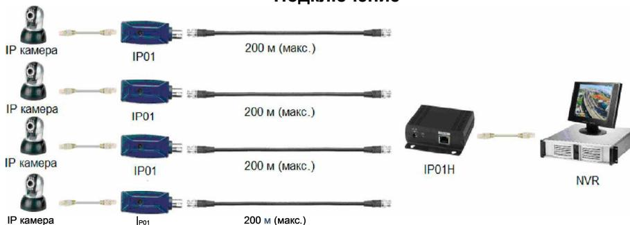
Рис. 2Схема подключения IP01H
