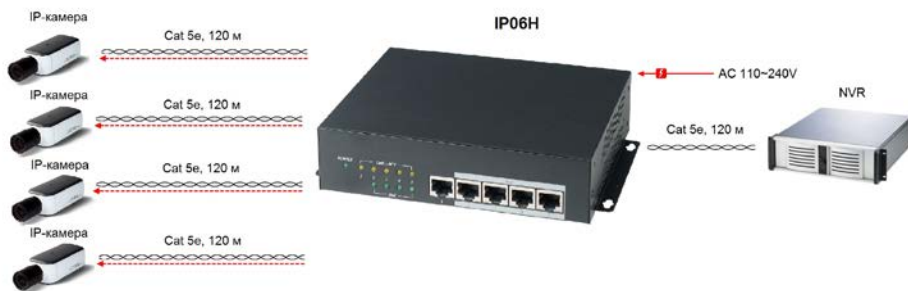
Рис. 5 Схема подключения PoE-коммутатора IP06H.
