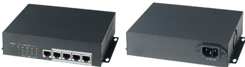
Рис. 1 Передняя и задняя панель PoE-коммутатора IP06H
