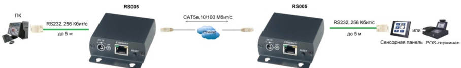
Рис. 3 Схема подключения RS005
