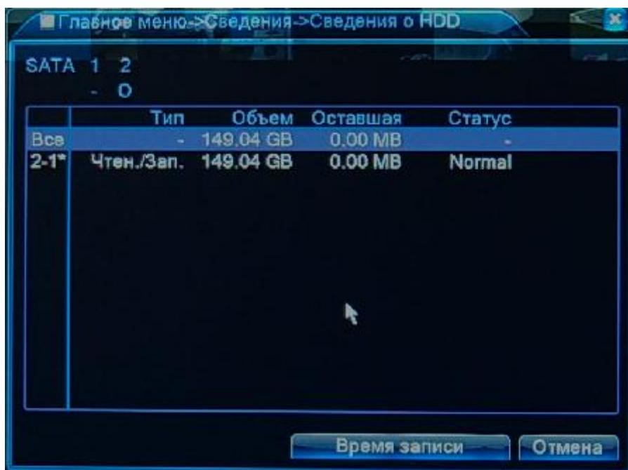
Примечание. Значок «\*» **2-1\*** рядом с номером диска обозначает, что диск исправен. Значок «?» обозначает, что диск неисправен. Значок «-» обозначает, что диск отсутствует.
