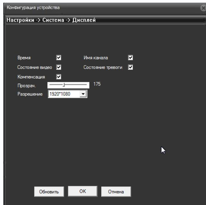
Можно включить отображение времени, отображение имени канала, статуса записи, информацию о битрейте камер, прозрачность меню и разрешение монитора.
