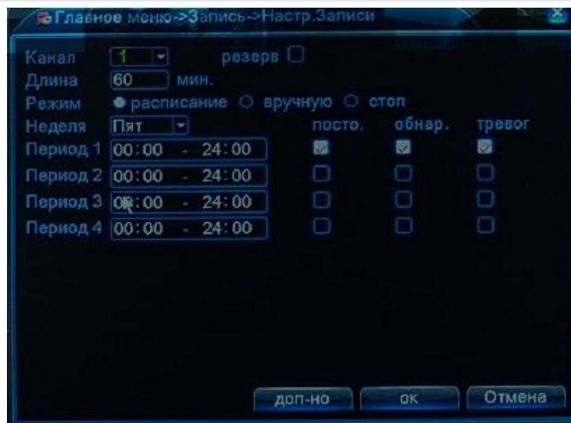
**Канал** – выбор канала, для которого производятся настройки записи. Можно выбрать один канал или все каналы одновременно.
