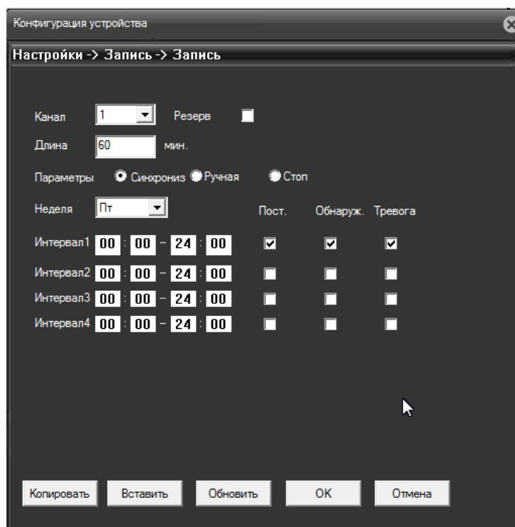
**Канал** – выбор канала, для которого производятся настройки записи. Можно выбрать один канал или все каналы одновременно.
