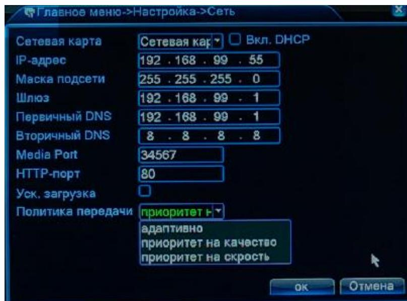
Можно задать получение адреса регистратором от DHCP (при этом необходимо, чтобы сервер DHCP был в сети) сервера при установке параметра **DHCP** либо вручную.
