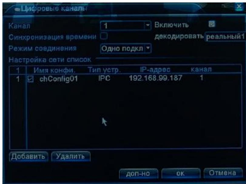
**Канал** – номер канала видеорегистратора, к которому привязывается IP камера. Регистратор TSr-NV0821 Light поддерживает до 8 каналов, регистратор TSr-NV0411 Light поддерживает до 4 каналов.
