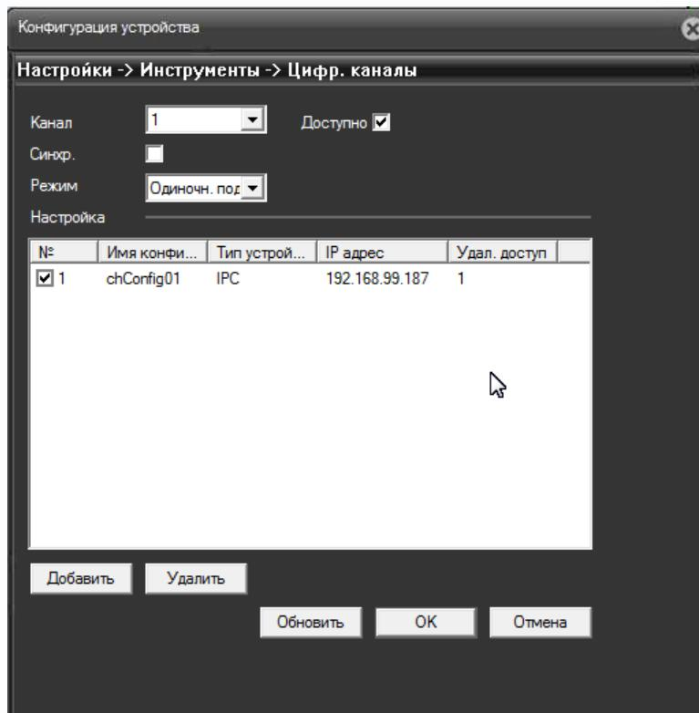
**Канал** – номер канала видеорегистратора, к которому привязывается IP камера. Регистратор TSr-NV0821 Light поддерживает до 8 каналов, регистратор TSr-NV0411 Light поддерживает до 4 каналов.
