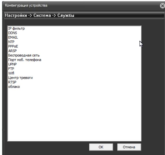
**IP – фильтр** – настройка списка IP адресов, с которых возможен или невозможен доступ к регистратору.
