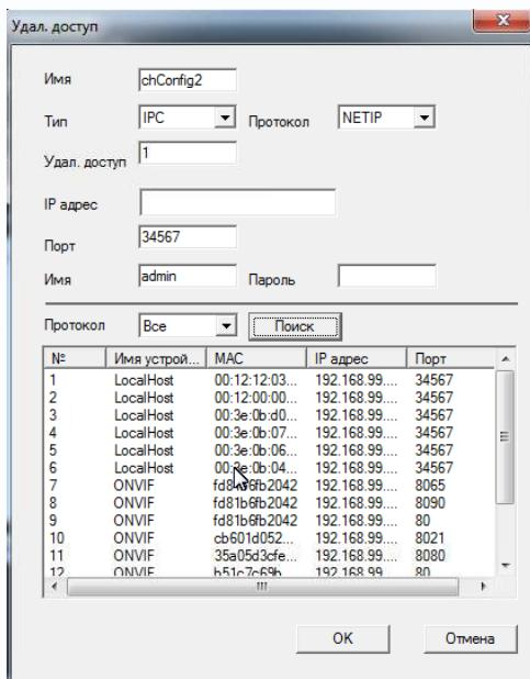
Для добавления найденной камеры выберите камеру в списке найденных, дважды щелкните мышью по камере и введите имя пользователя и пароль камеры, после чего нажмите **OK**. Камера появится в списке камер для выбранного канала. Поставьте галочку напротив камеры в списке камер.
