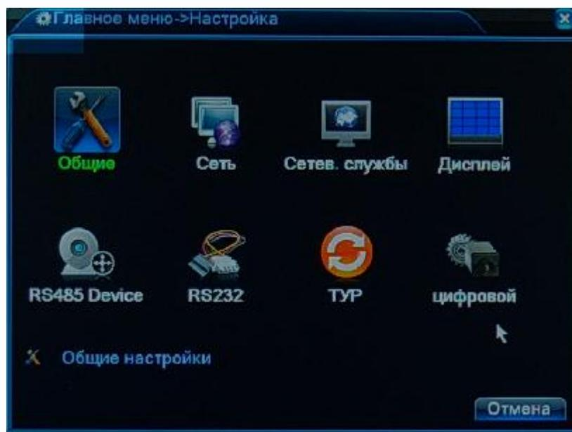
В данном меню производятся основные настройки даты и времени регистратора, выбор языка интерфейса, перезапись или остановка записи при заполнении HDD, стандарт видеовыхода BNC, настройка интервала автоматического отключения пользователя (**Авто выход**) и настройка имени устройства.
