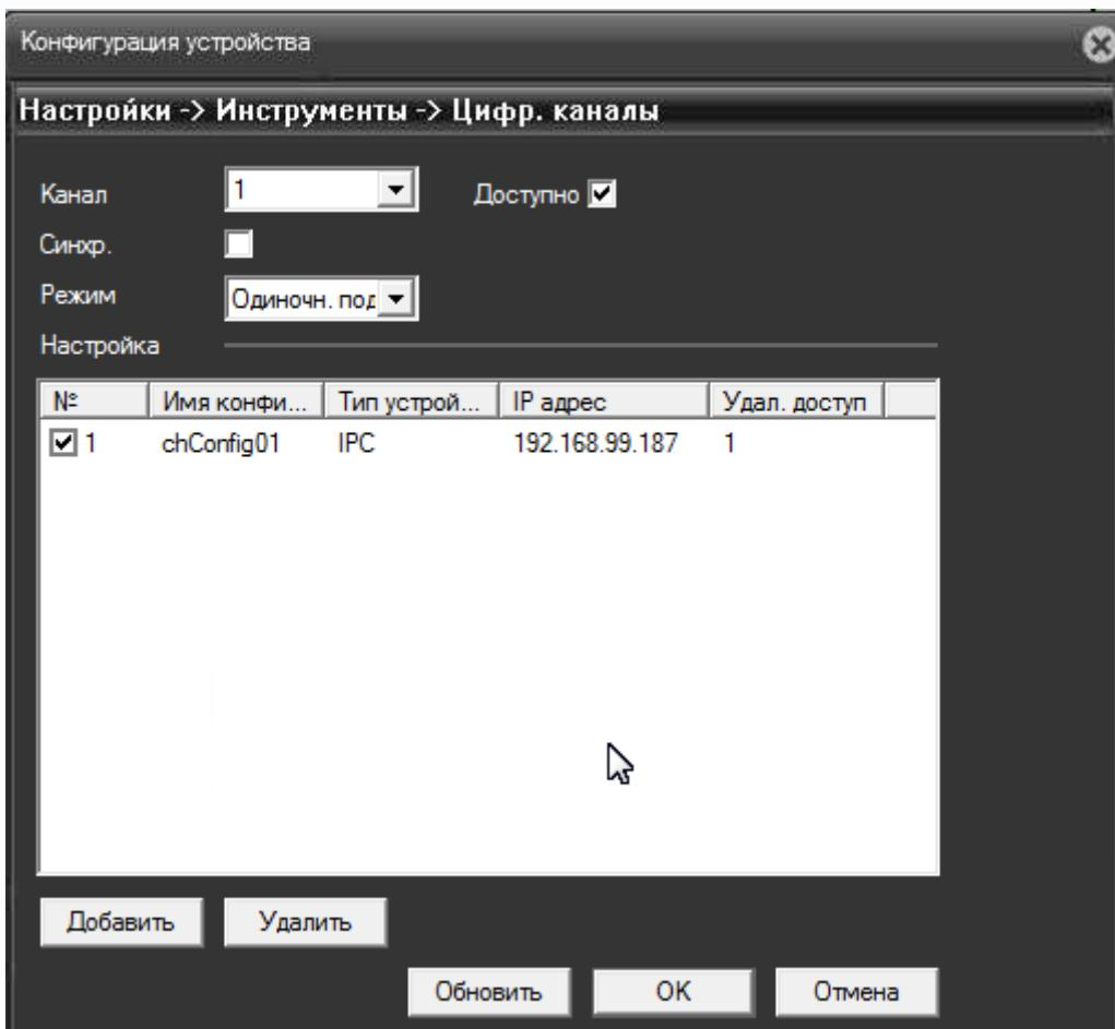
Нажмите **OK**. Добавленная камера через некоторое время после выхода из меню отобразится на мониторе.
