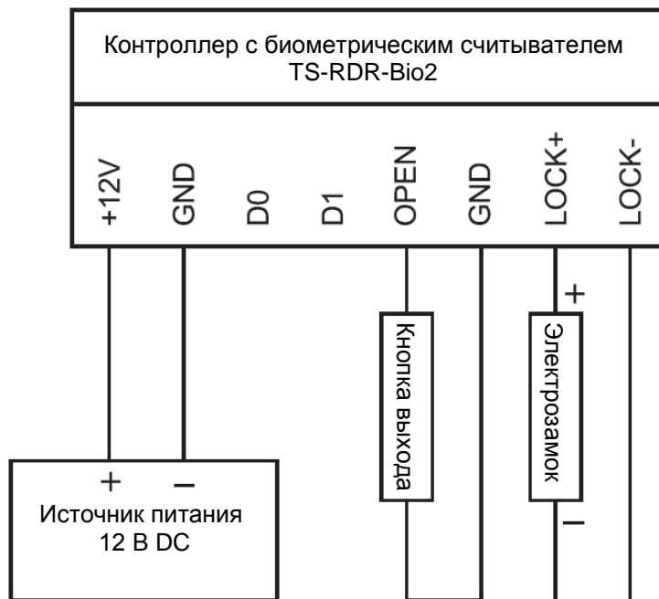
Рисунок 3. Схема подключения контроллера доступа
